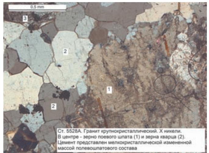
Рис. 9.7.13. Гранит крупнокристаллический, ст. 5528А, микрофото, X николи, фракция 10–25 мм. В центре – зерно полевого шпата (1) и зерна кварца (2)
