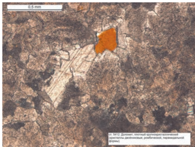
Рис. 9.7.8. Доломит плотный крупнокристаллический, ст. 5412, микрофото, II николи, фракция 10–25 мм. Кристаллы двойниковые ромбической пирамидальной формы
